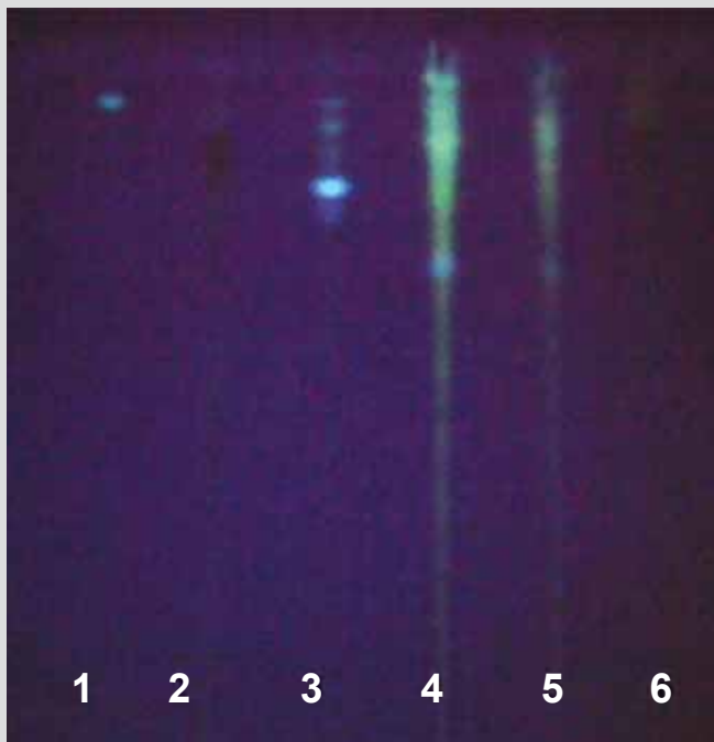
Фигура №: 2 TLC – хроматограма (т.1- Стандарт ОТА; т.2-изолат 119; т.3- изолат 27C , т.4- изолат 18 т.5- изолат 83А; т.6- изолат 53)
