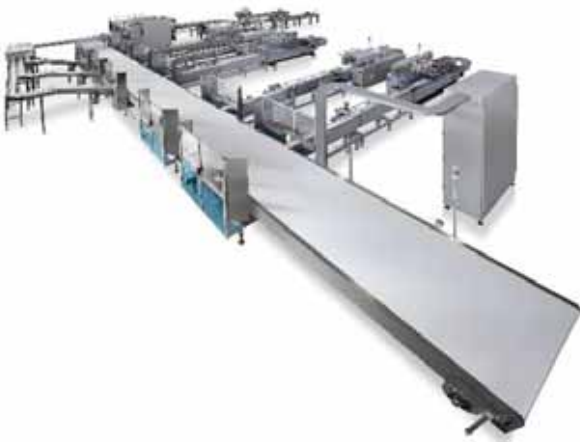
Напълно автоматизирана система за подреждане, буферирание и подаване на хлебни и сладкарски изделия към 4 хоризонтални флоупак опаковъчни машини и последващо автоматично кашониране
